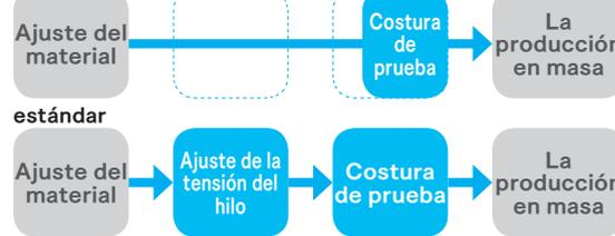
La producción en masa se puede iniciar rápidamente debido a que proporciona un ajuste adecuado de la tensión de hilo independientemente del tipo de hilo.
